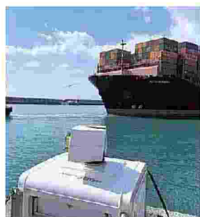
Le banchine di Pra': uno dei 23 anemometri sistemati nei porti dell'Alto Tirreno
